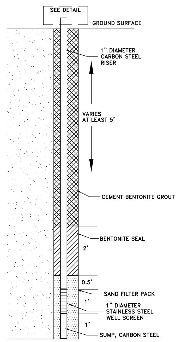
TYPICAL ABOVE GRADE VAPOR PROBE COMPLETION DETAIL
