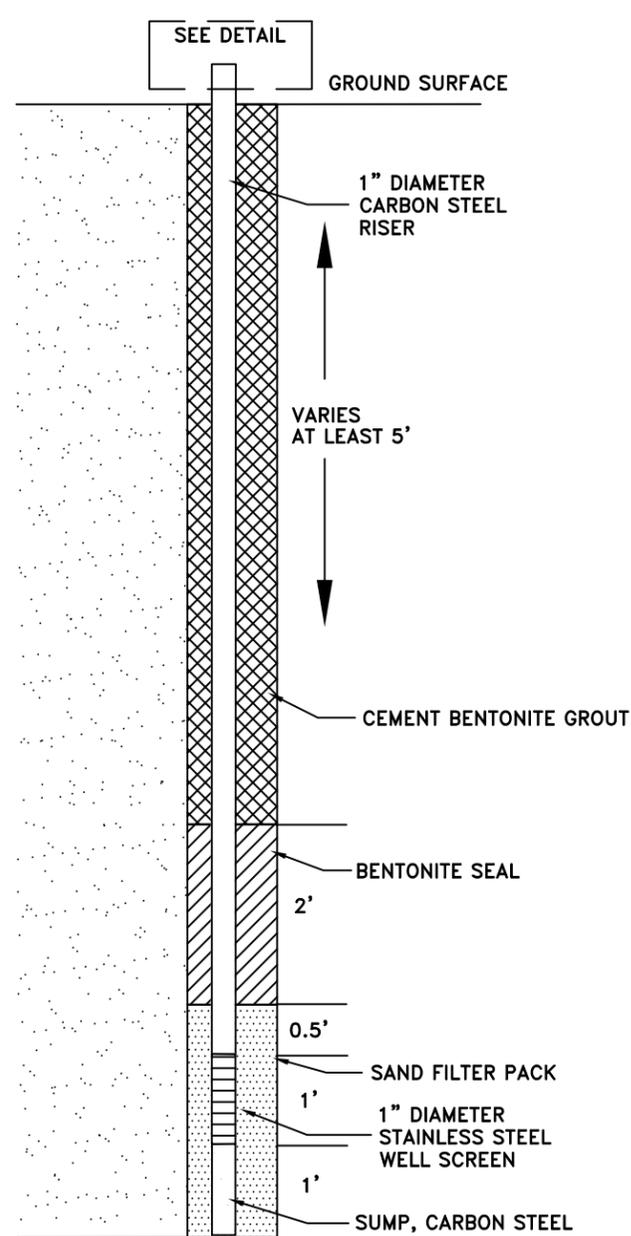
TYPICAL ABOVE GRADE VAPOR PROBE COMPLETION DETAIL
